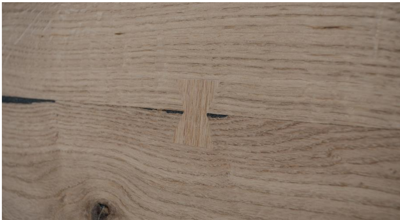
DUB S TRHLINAMI A-Doskový charakter - Schwalbenschwanz Povrch nosiča jednostranne zafarbený na čierno
